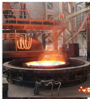
真空脱碳炉（VOD）
